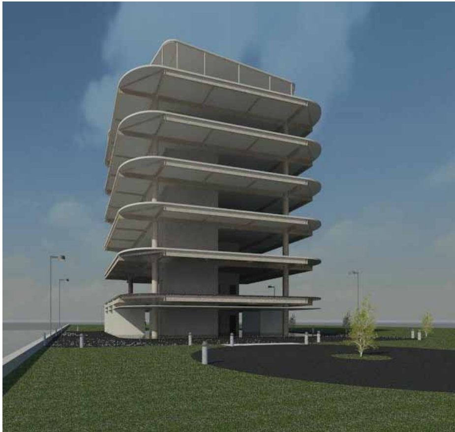
Figur 11 Bærende model fra Revit Structure af den modificerede udgave af Punkthuset
