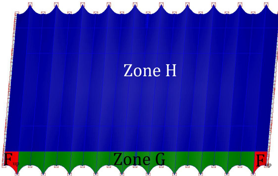
FIGUR 8-9: ZONEINDELING FOR VINDRETNING \theta=90^\circ
